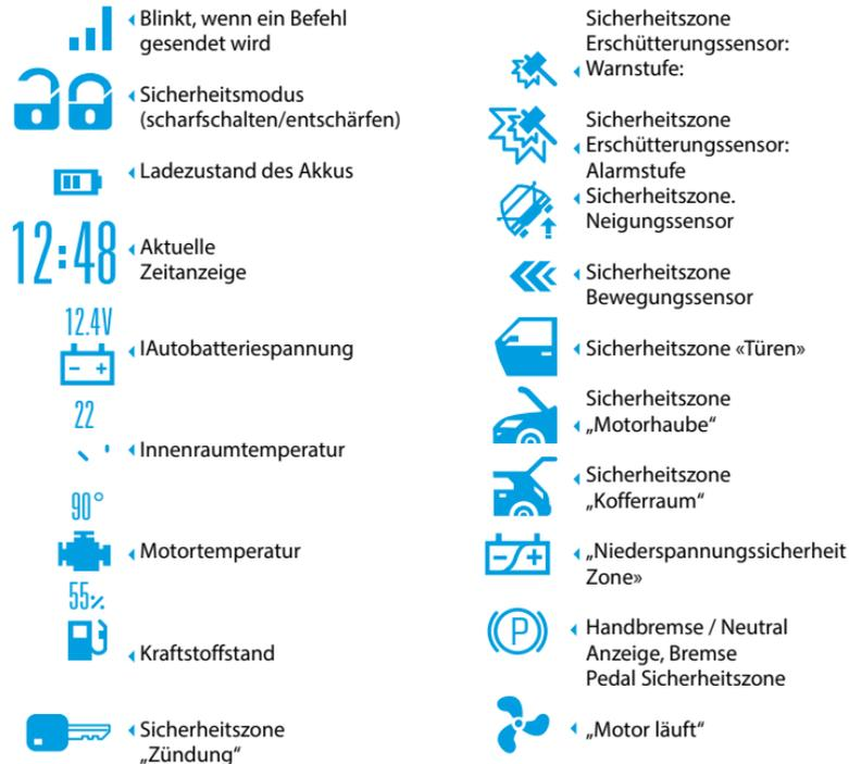
\*Die separate Anzeige der Türen, des ursprünglichen Alarmstatus und des Kraftstoffstands hängt von den Informationen im digitalen CAN-Bus-Protokoll eines bestimmten Fahrzeugs ab.
