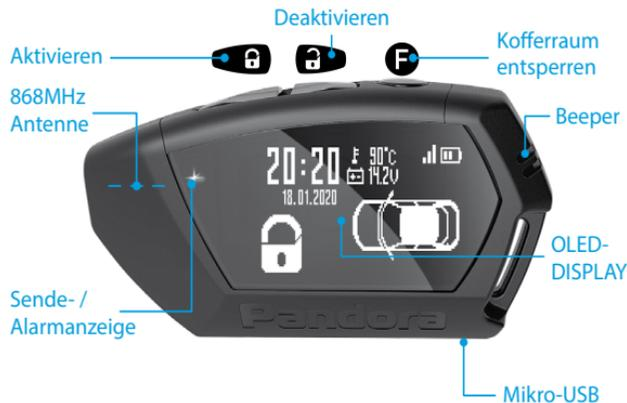
Die Fernbedienung ist im Auslieferungszustand voll funktionsfähig. Halten Sie zum Einschalten der Fernbedienung die Taste 3 Sekunden lang gedrückt. Der Klingelton „REMOTE ON“ wird abgespielt. Wenn Sie diese Taste erneut 3 Sekunden lang gedrückt halten, wird die Fernbedienung ausgeschaltet.
