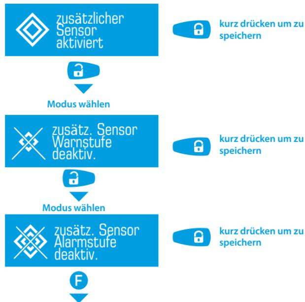
Um eine schnelle Ferneinstellung der zusätzlichen Sicherheitszonen des Sensors zu erhalten, wählen Sie durch kurzes Drücken der Taste **F** das Untermenü «Einstellungen der zusätzlichen Sensoren. Warnstufe» oder «Einstellungen der zusätzlichen Sensoren. Alarmstufe». Die Sensorempfindlichkeit kann durch kurzes Drücken der Taste **↔** und **↔** eingestellt werden.
