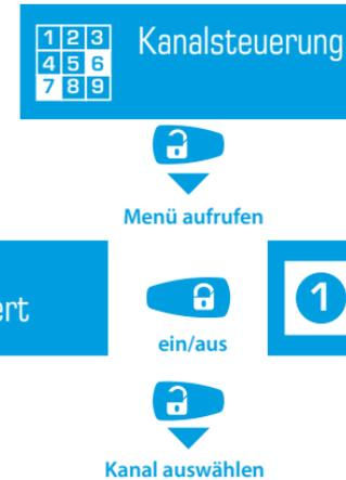
Drücken Sie kurz die Taste , um zwischen den Kanälen 2,3 und 4 zu wechseln.
