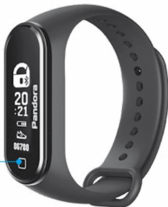
! PANDORA BAND IST EIN EINHEITLICHES STEUERGERÄT. SEIN BETRIEB HÄNGT VON DER FUNKTIONALITÄT DER ALARMANLAGE AB. ES IST ERFORDERLICH, DIE OPTION «D-030 ALS TRANSPONDER VERWENDEN» ZU AKTIVIEREN, UM BAND ALS AUTORISIERUNGSGERÄT EINES BESITZERS ZU VERWENDEN.
